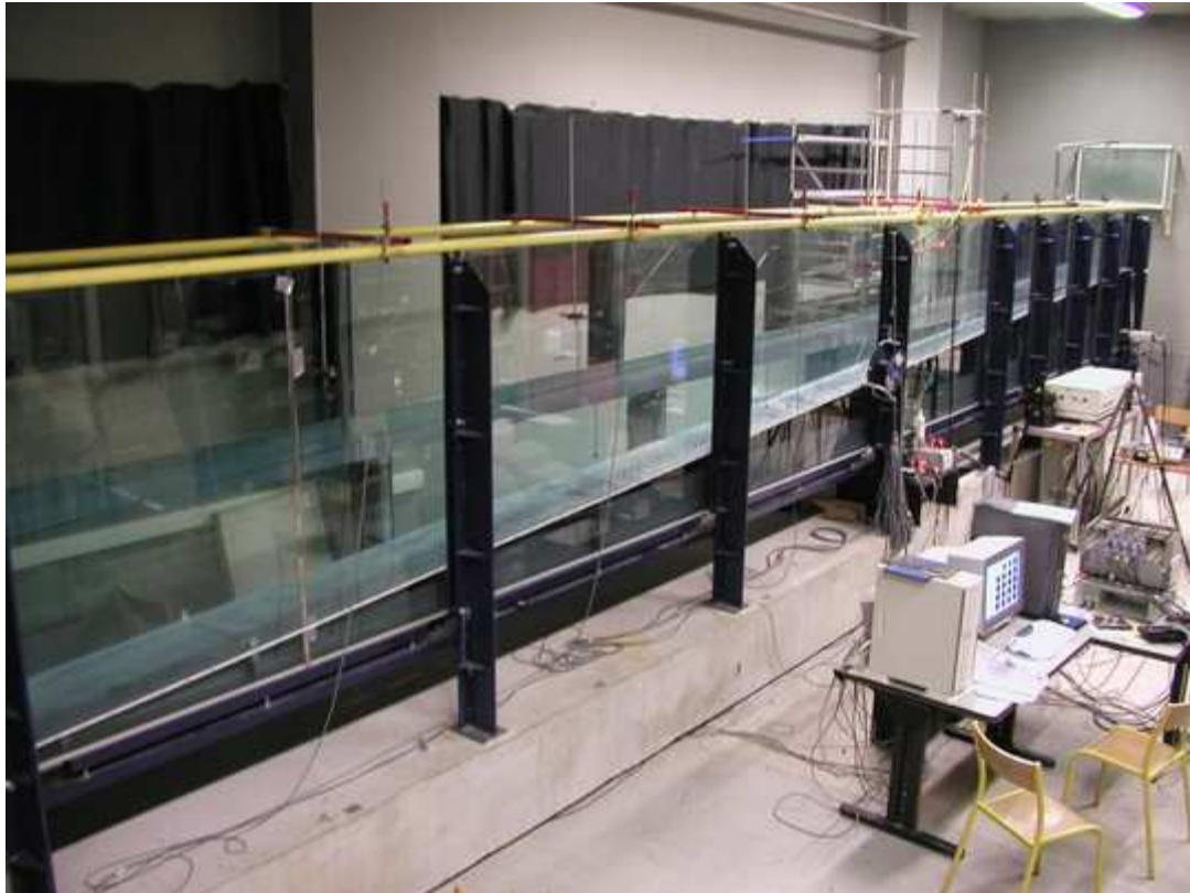
Expérience PIV : Déferlement d'une houle régulière sur une plage inclinée Kimmoun et Branger (2007)
