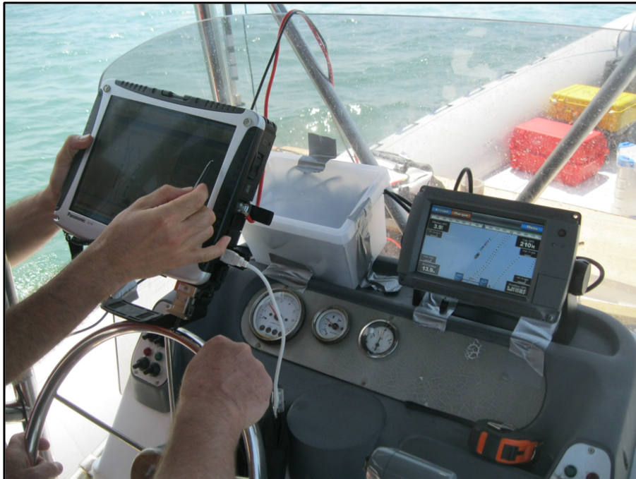
FIGURE D.7 – Image du poste de pilotage. La trajectoire du bateau est contrôlée avec le logiciel HYPACK . Le sondeur permet de visualiser la profondeur, la vitesse et le cap du bateau.
