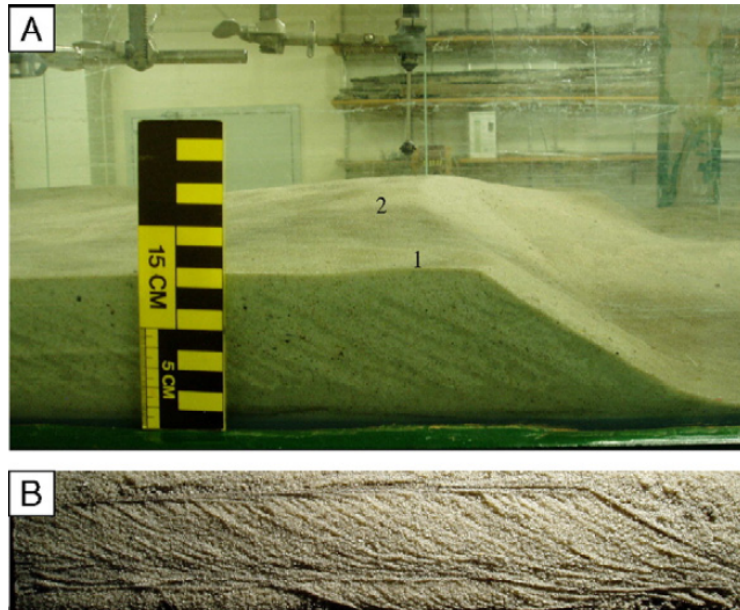
FIGURE 1.2 – Dune soumise à un courant stationnaire sur laquelle migrent des formes surimposées (a) et enregistrement stratigraphique associé (b). Image de Reesink et Bridge (2007)
