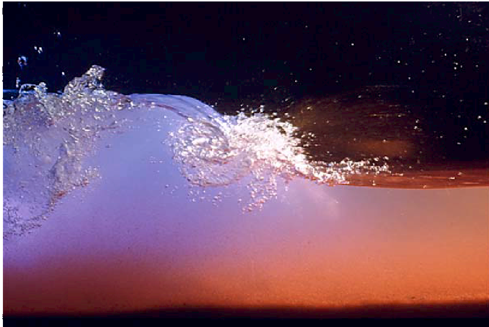
Figure 1.4: Déferlement d'une vague sur un fond granulaire dans le canal à houle du LEGI (photo prise par E. Perrin, CNRS).
